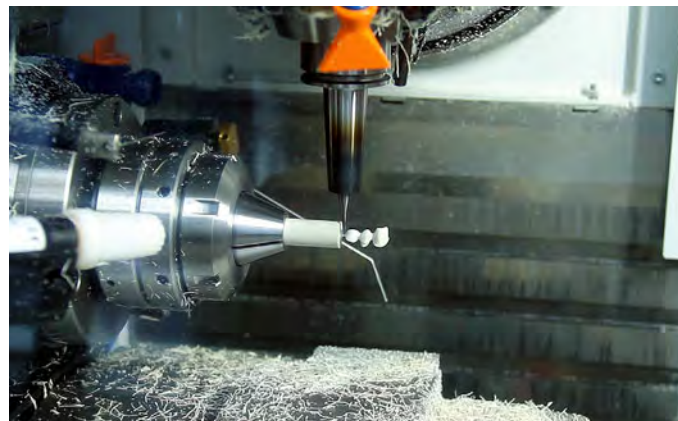
Usinage d'une armature de bridge.
